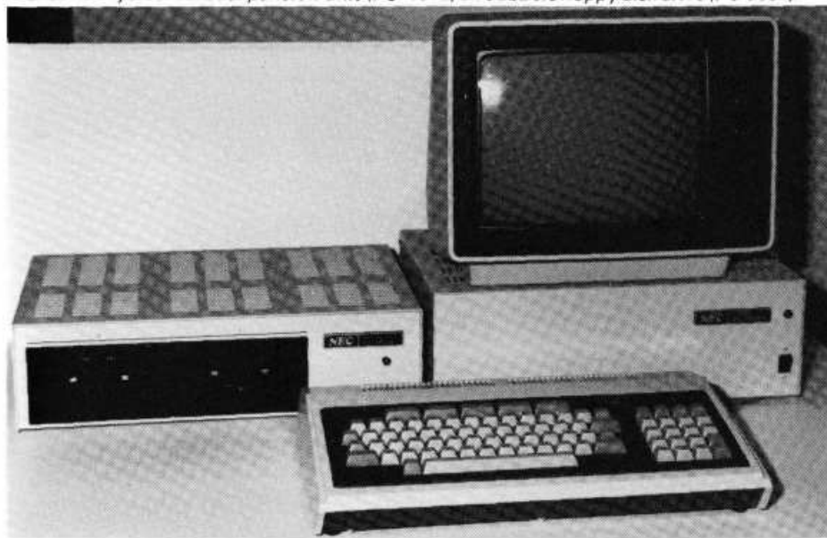
Afb. 5. Een systeem met expansion unit (PC-8012) en dubbele floppy disk drive (PC-8031).
